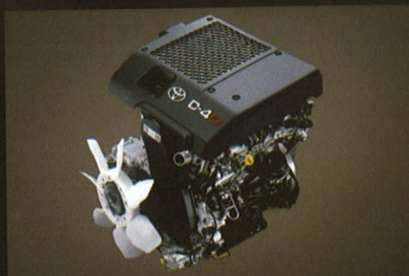
Motor turbo diesel intercooler. 163 cv – a maior potência da categoria.
