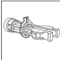
**5** Para substituir o filtro, ou instalar um novo filtro, primeiro certifique-se de que o filtro esteja orientado corretamente com a aba plástica voltada para cima. Se o filtro não estiver orientado corretamente, uma aba saliente evitará que o filtro se encaixe no lugar.
